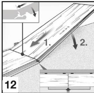
Ein zweites Paneel stirnseitig (kurze Seite) mit einem Winkel von 30° in die Nutprofilierung des voran liegenden ersten Paneels einfügen und dann auf den Boden flach ablegen. Darauf achten, dass die Längskanten in einer Flucht liegen, keinen Versatz sowie eine gerade Linie bilden. Dies ist notwendig, um bei der Verlegung der 2. Reihe die Paneele fugenfrei in die Längsprofilierung einsetzen zu können. Weitere Paneele bis zum Ende der 1. Reihe in dieser Verlegeart anfügen.
