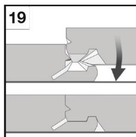
Ein zweites Paneel längsseitig in die Nutprofilierung der voran liegenden Paneelreihe einlegen und in einem Winkel von 20° nach links
