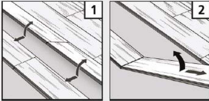
Der Rückbau schwimmend erfolgt in dem zunächst die gesamte Reihe längsseitig durch Anwinkeln aus der Verriegelung gelöst wird. Anschließend werden die Paneele kopfseitig flach auf dem Boden liegend an der Schmalseite angewinkelt und die Verbindung gelöst.
