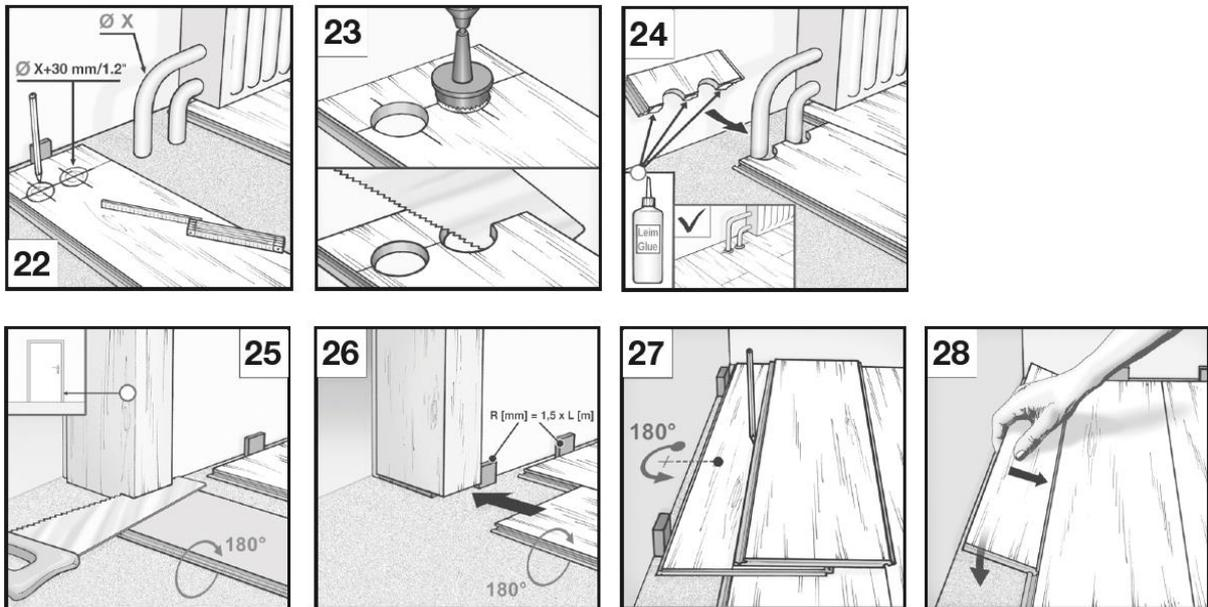
Für Heizungsrohre müssen Lochbohrungen, die 3 cm größer sind als der Rohrdurchmesser, ausgespart werden. „Einpassstück“ aussägen, beleimen, einpassen und mit einem Keil bis zur Aushärtung des Leimes fixieren. Anschließend Aussparungen mit Heizkörpermanschetten verkleiden. Holztürrahmen soweit kürzen, dass ein Paneel mit Trittschalldämmung inkl. 2 – 3 mm Abstand darunter passt. Nach der Verlegung Abstandskeile entfernen.
