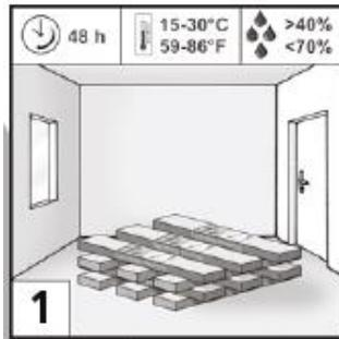
Böden vor dem Verlegen mindestens 48 Stunden in der ungeöffneten Verpackung bei Zimmertemperatur waagrecht im Raum lagern. Vor, während und mindestens drei Tage nach der Verlegung müssen die folgenden raumklimatischen Bedingungen gewährleistet sein:
