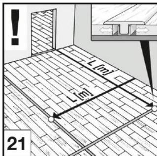
Bei Verlegeflächen mit mehr als 8 m Länge bzw. Breite und bei stark verwinkelten Räumen sind Dehnungsfugen (mind. 2 cm Breite) erforderlich. Nur dann kann sich der Boden bei klimatischen Änderungen entsprechend ausdehnen oder zusammenziehen. Beachten Sie dies auch bei einer raumübergreifenden Verlegung. Hier müssen die Flächen im Türzargenbereich unterbrochen werden. Bewegungsfugen können mit entsprechenden Profilen fachgerecht abgedeckt werden.
