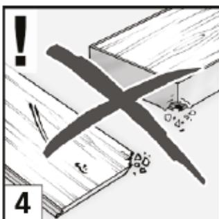
Überprüfen Sie die einzelnen Dielen vor dem Verlegen bitte nochmals auf Schäden, Maße und optische Gleichheit der Oberfläche bei Tageslicht am Verlegeort.
