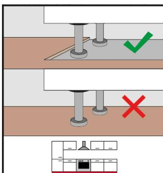
Einbauküchen und Einbauschränke müssen vor der Verlegung aufgebaut werden. Der Aufbau auf den Bodenbelag ist nicht zulässig.
