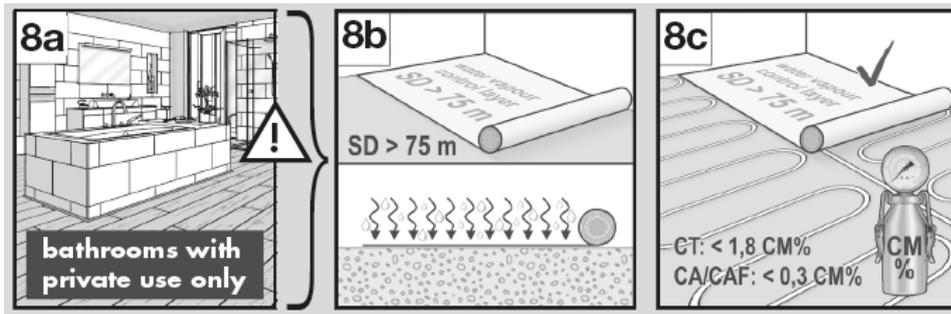
Der Boden ist für die Verlegung in Bädern geeignet. Bitte beachten Sie die nachfolgenden Verlegehinweise. Für Unterböden mit und ohne Fußbodenheizung muss der Fachverleger vor der Bodeninstallation die notwendige CM Messung vornehmen und protokollieren. Bei der Verlegung auf mineralischen Untergründen, muss eine Feuchtigkeitsmessung erfolgen. Folgende Restfeuchtigkeit darf der Estrich vor der Verlegung nicht überschreiten:
