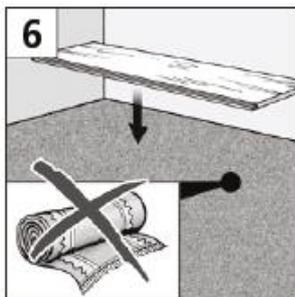
Teppichböden müssen immer entfernt werden. Durch den unter dem Boden liegenden Teppich kommt es beim Begehen der Fläche zu einer federnden Bewegung und zu starkem Druck im Kantenbereich. Dies zerstört die Nut-Feder-Verbindung und führt zu einer Fugenbildung.
