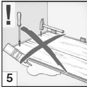
Der Boden wird schwimmend verlegt und darf nicht auf den Unterboden geklebt, verschraubt, genagelt oder auf andere Weise fixiert werden.
