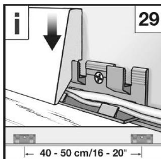
Für den perfekten Abschluss befestigen Sie die Sockelleistenklammern im Abstand von 40 – 50 cm an der Wand, und stecken die passend zugeschnittenen Sockelleisten auf.
