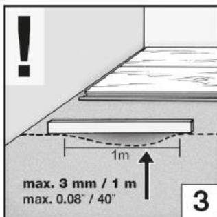
Der Untergrund muss so beschaffen sein, dass der Boden entsprechend der Anleitung verlegt werden kann. Als Untergrund eignen sich u.a. mineralische Untergründe (wie z.B. Estrich, Beton, Asphalt), der absolut eben, trocken, sauber und tragfähig sein muss.
