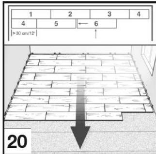
Zur Vermeidung von Kantenabsplitterungen sollte die Dekorseite bei der Nutzung von elektrischen Stich- oder Handkreissägen nach unten zeigen. Ansonsten von der Paneeloberseite her absägen. Jede neue Reihe mit dem Reststück (mindestens 30 cm Länge) der vorhergehenden Reihe beginnen.
